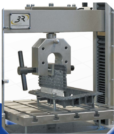
Un test de résistance de trappe d'airbag
