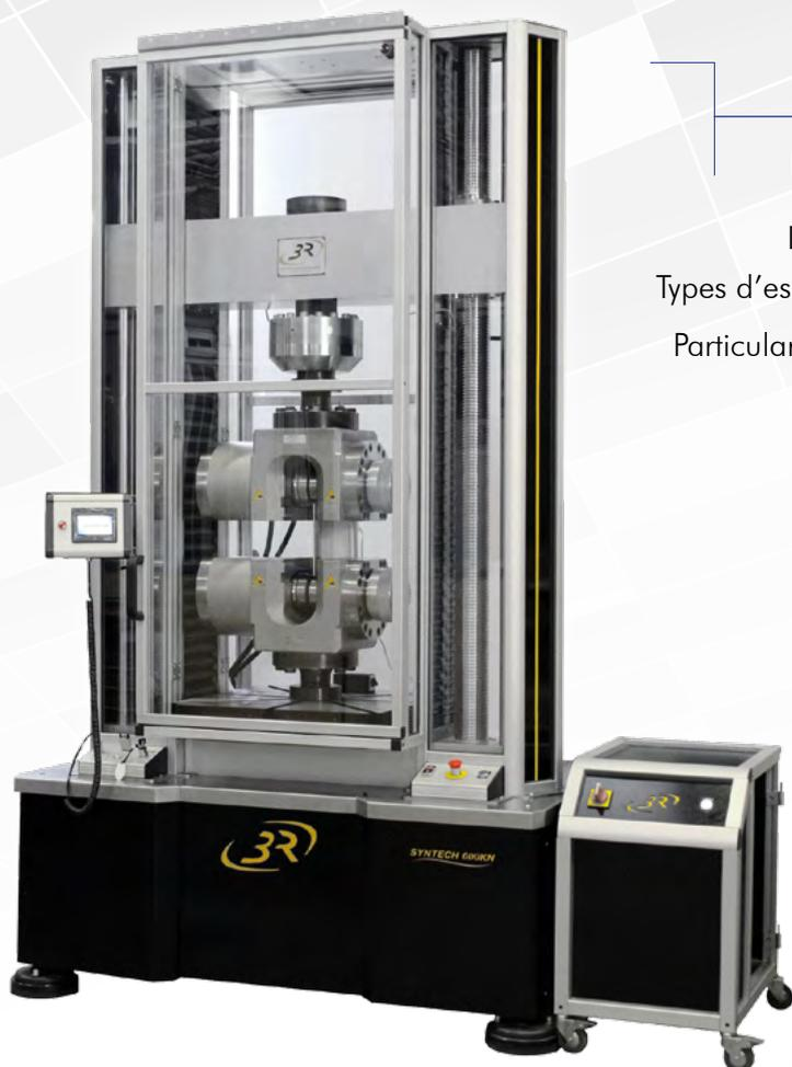
Bâti: Machine de traction 600kN
