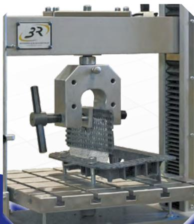
*Essai de résistance d'une trappe d'airbag*
