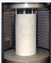
Essais de compression sur cylindres 15 x 30 & 16 x 32
