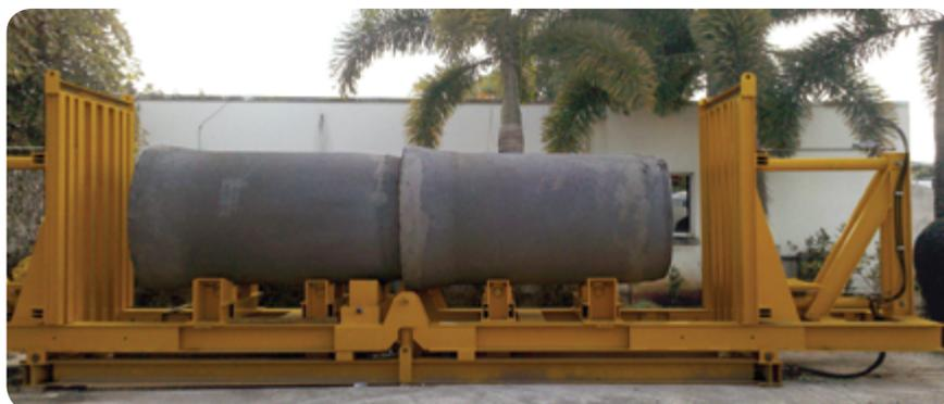
Pour chacune des dimensions de Tuyaux, 3R réalise également des bancs d'étanchéité conformes à la norme EN 1916.
