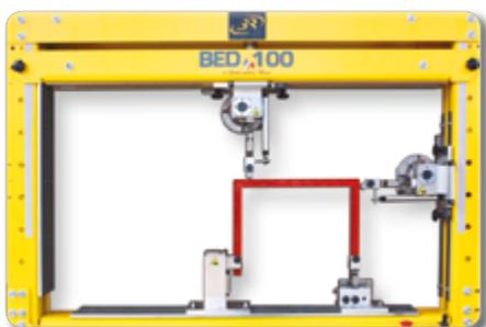
Les actionneurs sont pilotés en force ou déplacement, il est donc possible d'appliquer une contrainte prédéterminée ou d'imposer un déplacement à la structure.
